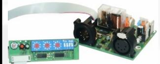
DMX Demultiplexer dekodieren DMX512 Signale in analoge Steuersignale (z.B. 0...+10V, 0...-10V). Dabei werden mehrere DMX Datenkanäle (DMX data slots) auf mehrere einzelne analoge Ausgänge aufgesplittet.
